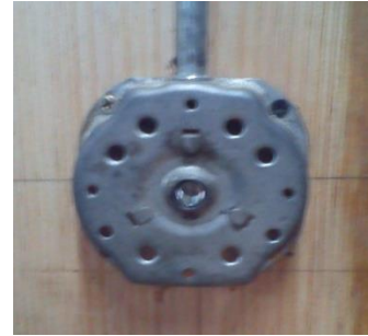
Fig. 6. Soporte de la armadura.
