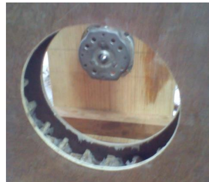
Fig. 4. Tapa circular para cubrir los imanes y evitar su caída
