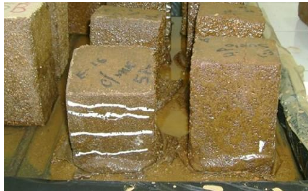
Figura 6: Deterioro de probeta elaborada con mucílago de nopal.
