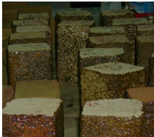
Figura 3. Recubrimiento de cuatro caras de las probetas con barniz epóxico transparente.
