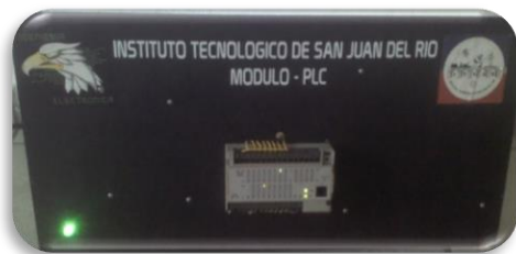
Figura 11. Controlador Lógico Programable Inalámbrico mediante protocolo ZigBee.
