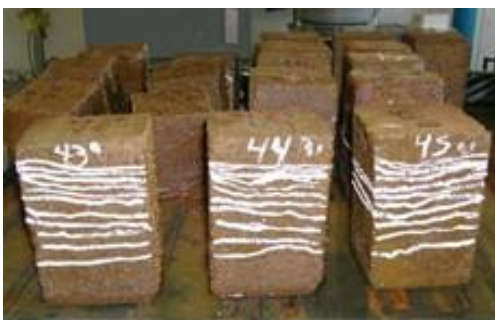
Figuras 9 y 10: Detalles de la velocidad de penetración de humedad en BTC elaborados con suelo, cemento y mucílago de nopal
