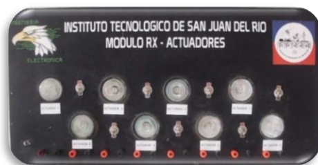
Figura 13. Módulo con Actuadores Inalámbricos mediante protocolo ZigBee
