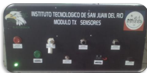
Figura 12. Módulo con Sensores Inalámbricos mediante protocolo ZigBee
