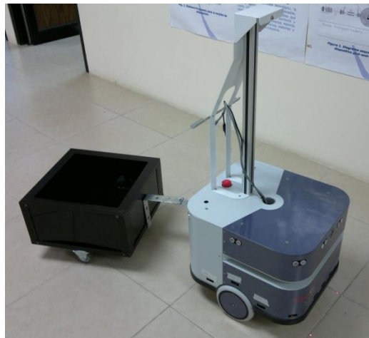
Figura 2. Prototipo de remolque acoplado al robot móvil Robulab
