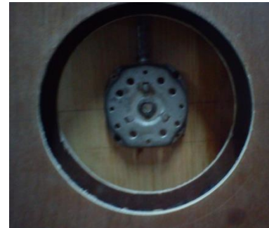
Fig. 7. Alineación de la base fija y la giratoria.
