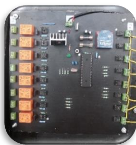
Figura 10 Modulo de Recepción de datos con XBee, decodificador y salida a relevador.
